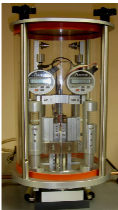
Рисунок А2 – Конструкция блока индикаторов
